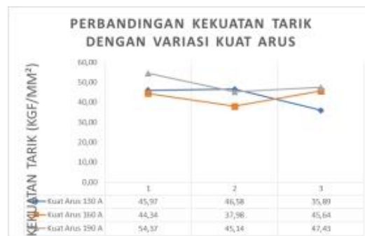
Gambar 12. Perbandingan Kekuatan Tarik Dengan Kuat Arus (Siswanto, 2011)
