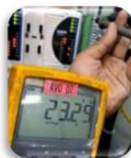
Gambar 11. Pengukuran Arus I/O Module dan Pressure Switch
