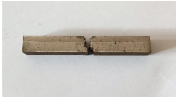
Gambar 7. hasil uji impact pegas daun tanpa pengelasan
