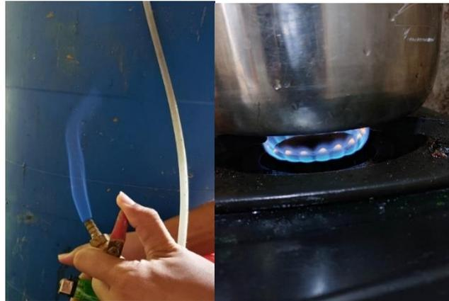
**Gambar 4.** Uji nyala api biogas
